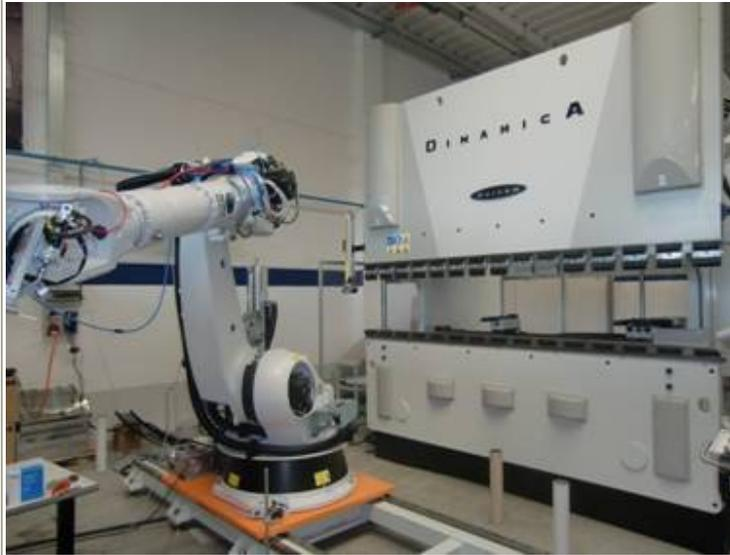
Cella di piegatura per Terzisti, con pressa Warcom 3000 mm. x 130 Ton. e Robot Kuka kr-210.
