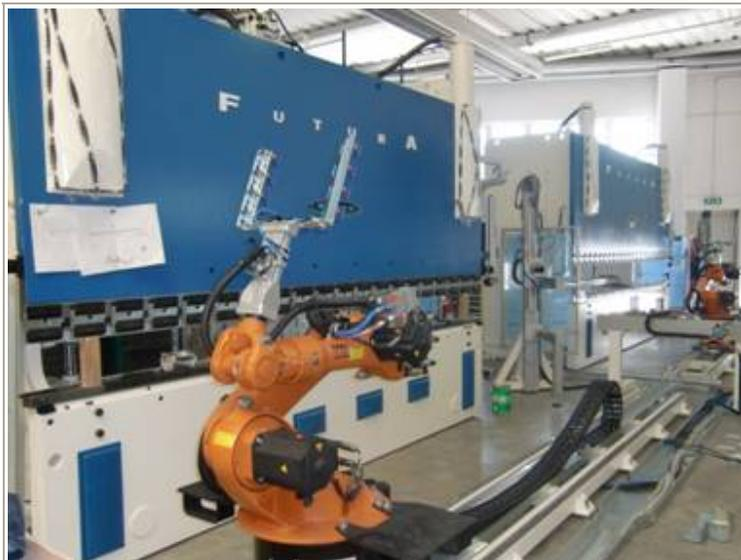
Cella di piegatura per la realizzazione di cappe da cucina, con una pressa Warcom da 5000 mm. e una pressa Warcom da 4000 mm. Il processo di piegatura ( 27 pieghe) avviene con 2 Robot Kuka KR-16. La programmazione avviene in off-line.
