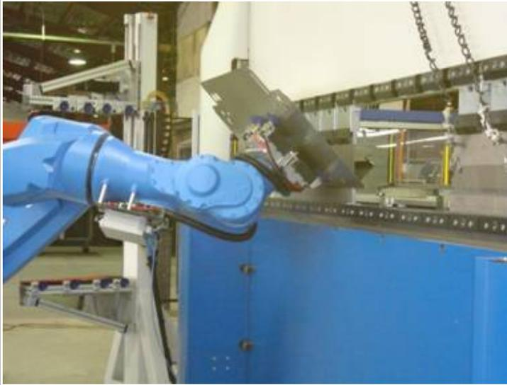
Cella di piegatura per Terzisti, con pressa LA-G 3000 mm. x 100 Ton. e Robot Staubli TX 200
