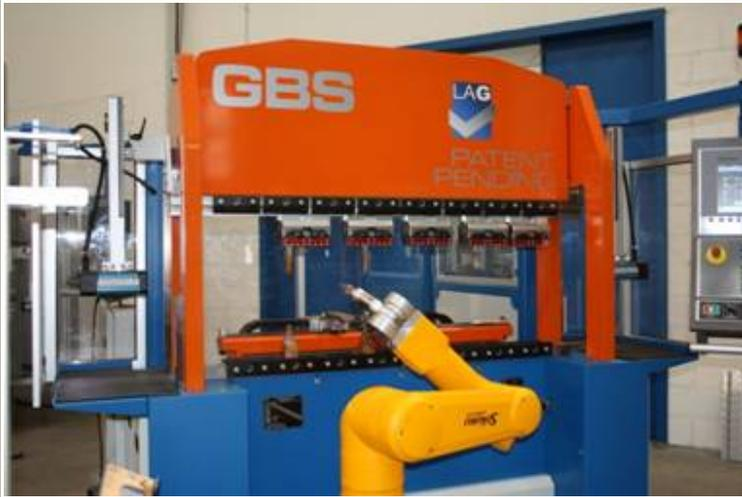
Cella di piegatura per Terzisti, con pressa LA-G 1250 mm. x 50 Ton. e Robot Kuka kr-16
