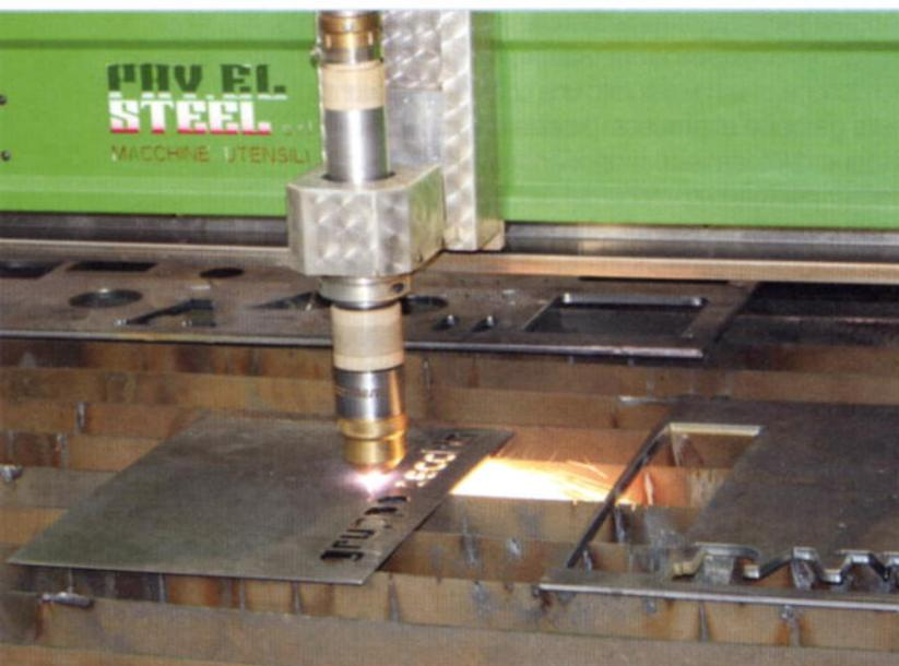
PAV.EL. Steel ha progettato e messo a punto Plasteel, una macchina al taglio plasma in HD.
