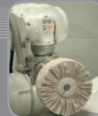
Spazzolatura lavandini Brushing washbasins
