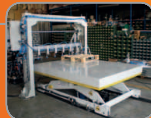
Caricatore cartesiano pannellatrice Cartesian loader for panelling machine
