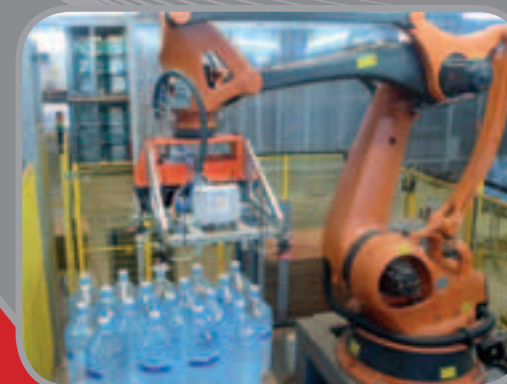
Pallettizzazione boccioni 4/5 G. Palletising 4/5 gal water tanks
