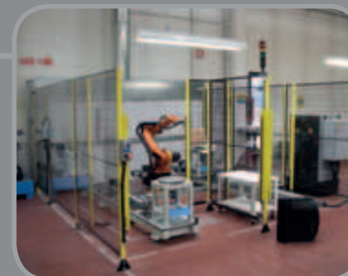
Deposito colla su sedute Depositing glue on chairs
