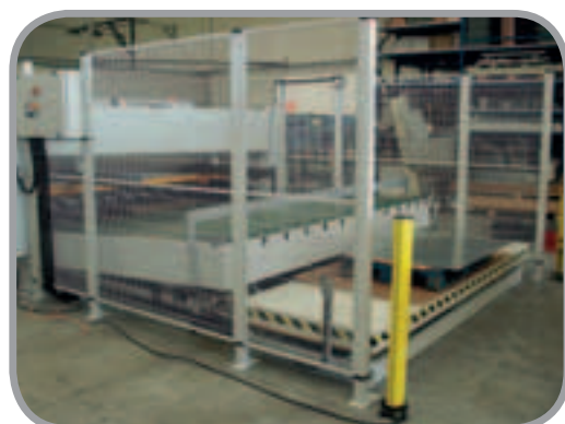
Scarico automatico cesoie Automatic unloading from shears
