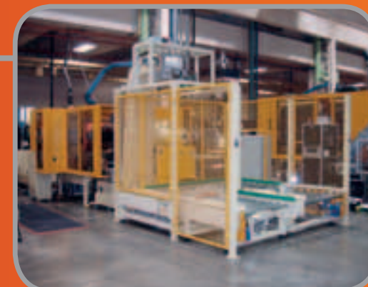
Scarico, pesatura e inscatolamento di stampati plastici Unloading, weighing and packing molded plastics
