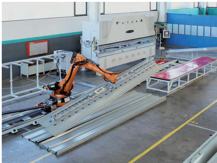
L'impianto di piegatura è composto da una macchina Warcom, modello Futura, e da un robot Kuka da 130 chili e portata al polso di 110 chili, che utilizza un particolare organo di presa a ventose.
